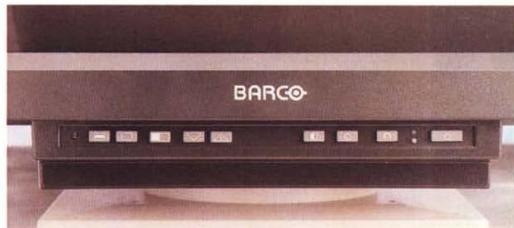
Trattandosi di un monitor da 21 pollici, le dimensioni esterne del Personal Calibrator non sono certo contenute. In basso i comandi, disponibili sul frontale, per accedere alle varie regolazioni (vedi testo).
